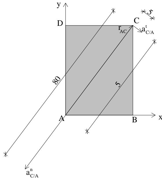
Vektorski zbroj normalne i tangencijalne komponente ubrzanja  $a_{C/A}$  odnosno ubrzanje od rotacije točke C oko točke A (koji je ujedno i ukupno ubrzanje točke C) odredimo očitavanjem iz crteža (plana ubrzanja) u mjerilu koje je odabrano za crtanje poznatih vektorova.
